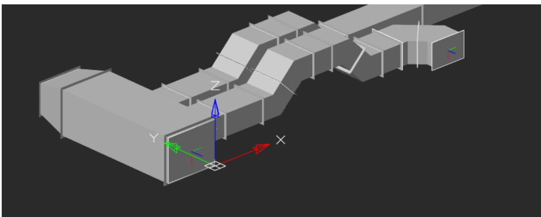
Пользователь выполнил проектирование фрагмента воздуховода и создал два коммита в своей ветке KosM. В результате работы он получил следующую модель воздуховода:
