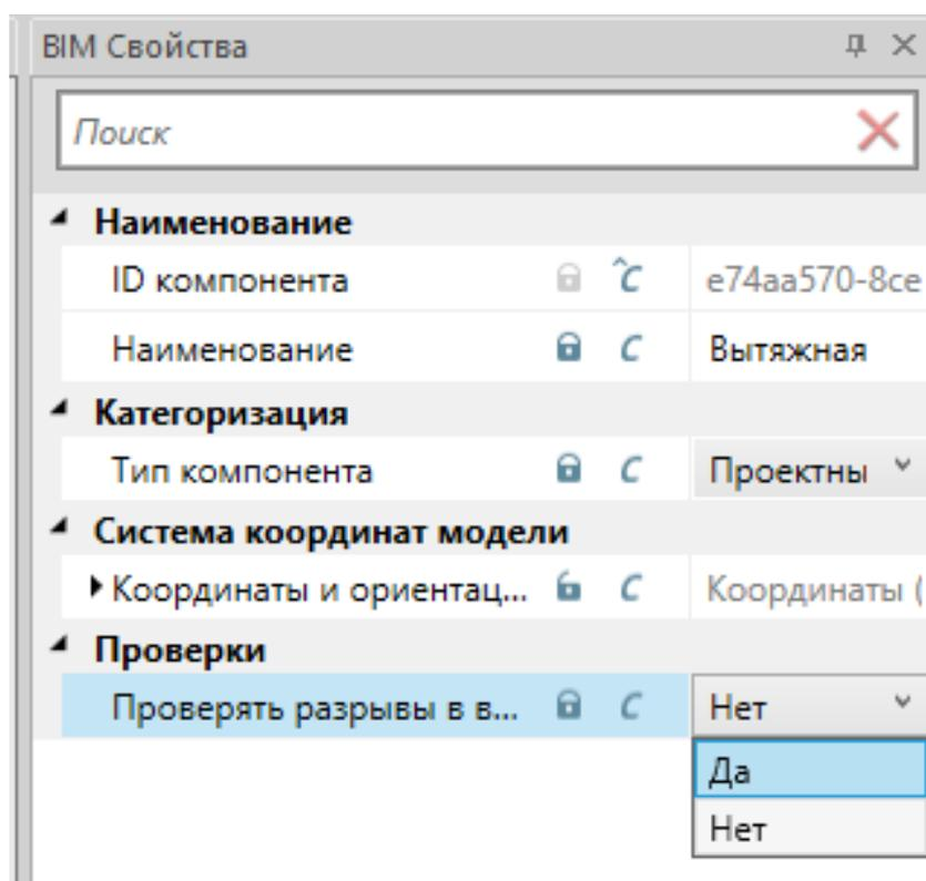
В компоненте с включенной опцией «Проверки» при обнаружении разрыва в системе в оповещении будет выводиться ошибка с указанием координат последнего элемента перед разрывом.
